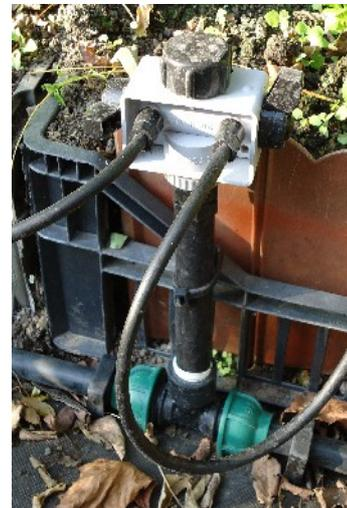
*Modulo distributore con prolunga e raccordo a tee di alimentazione sul tubo da 16 mm.*
