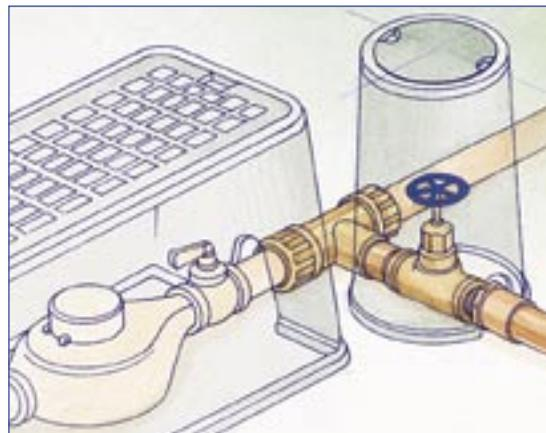
*Regioni Temperate: Raccordo a Tee a compressione in ottone per collegare l'impianto di irrigazione all'alimentazione in acqua della casa.*
