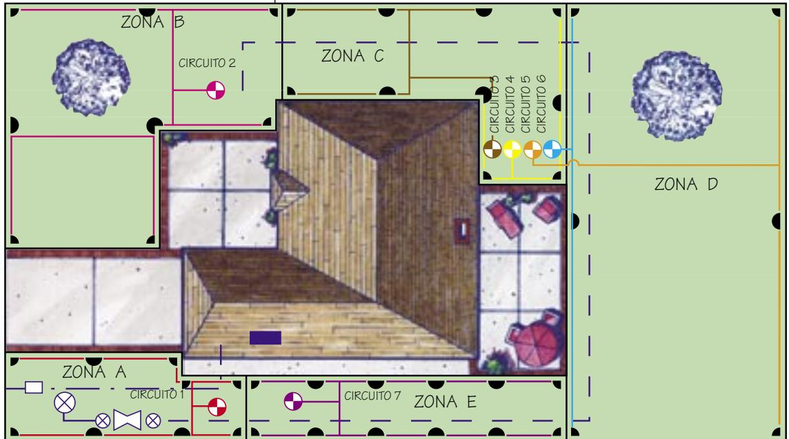
Determinare il luogo dove si desidera posizionare il blocco di distribuzione di ciascun circuito: nella parte anteriore del giardino, sul retro oppure in più punti. Il blocco di distribuzione può essere situato ovunque, tuttavia si consiglia di installarlo in un punto facilmente accessibile per la manutenzione. Situare il blocco di distribuzione vicino alla zona servita dalle valvole ma in un punto in cui non si venga bagnati se si deve mettere in funzione l'impianto manualmente.
