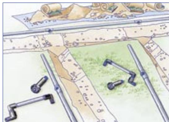
Disporre i tubi e gli irrigatori lungo le trincee, in corrispondenza del punto in cui verranno installati.
