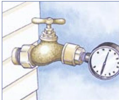
Per verificare la pressione dell'acqua fissare un manometro ad una presa, il più vicino possibile al contatore. Il manometro può essere acquistato presso il proprio rivenditore locale Hunter.
